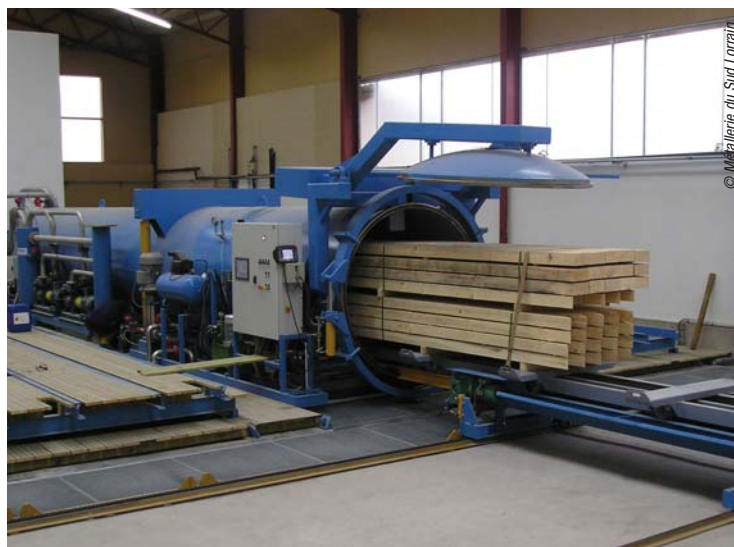
Traitement d'une charpente par autoclave.
