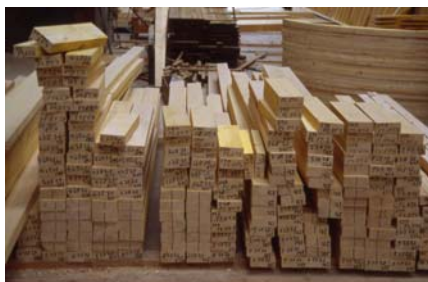
Tous les composants bois sont identifiés et repérés afin de réaliser les panneaux de façade.
