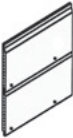
Lames horizontales avec embrèvement simple
