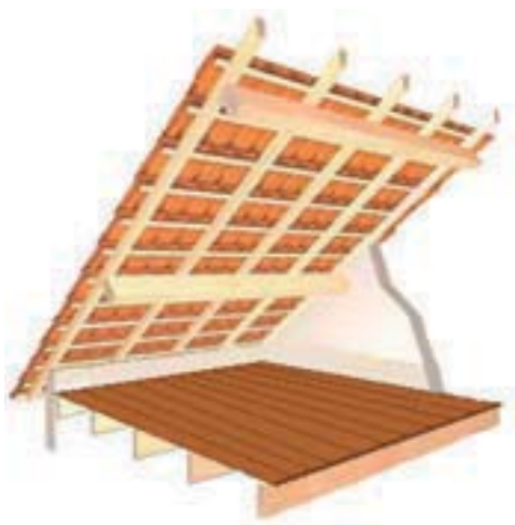
Grenier et charpente industrielle à combles aménageables (Source FCBA)
