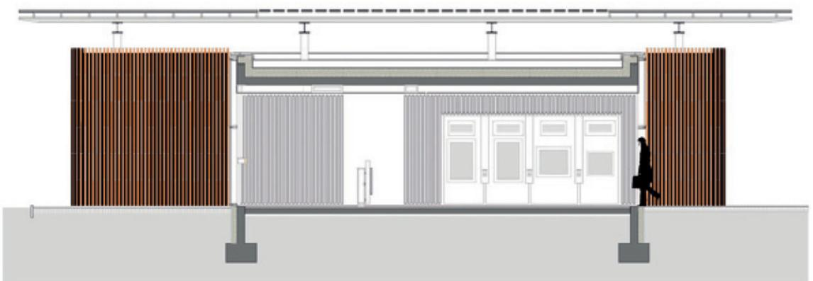
Coupe mettant en évidence la surtoiture, formée d'une charpente d'acier galvanisé, supportant directement un tissage de panneaux photovoltaïques bi-verre et de bardeaux de terre cuite.
