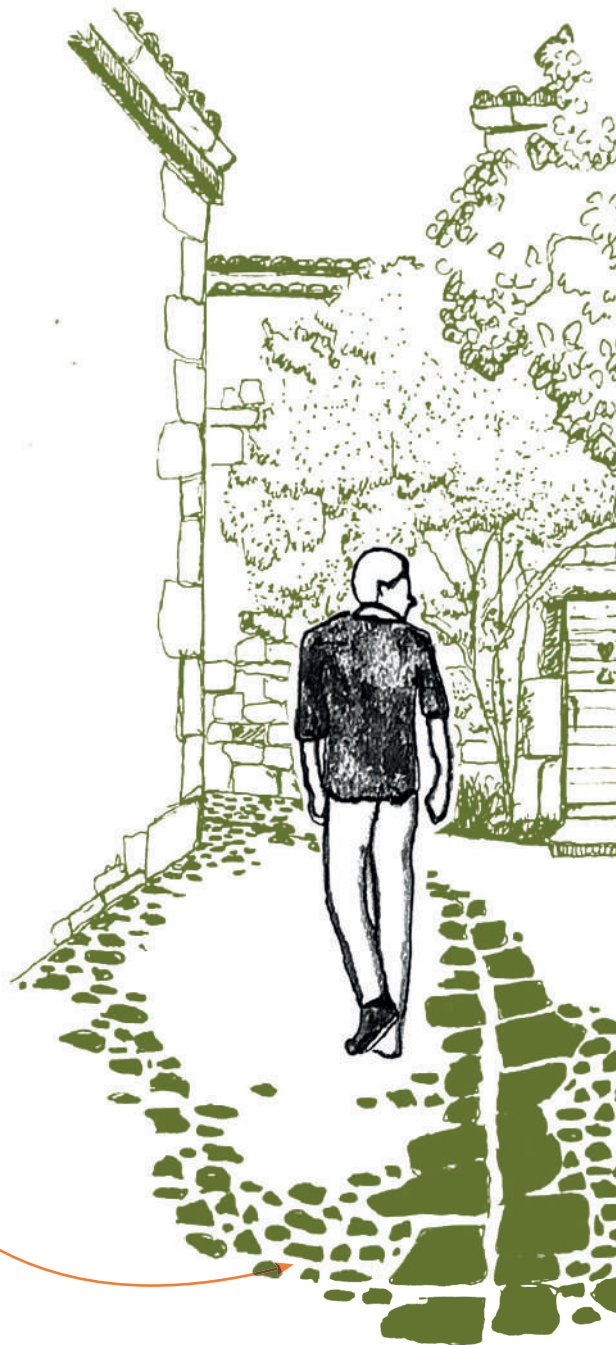
Calade en dalles et galets basaltiques Galets sciés de taille variable
