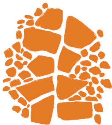
Calade en dalles et galets basaltiques Galets sciés de taille variable
