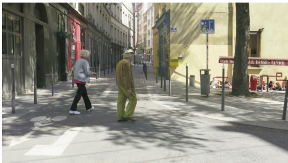
Traversée suggérée en carrefour équipé de BEV, mais sans marquage de passages pour piétons
