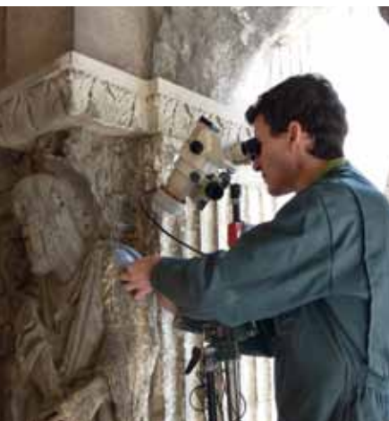
Examen in situ à la loupe bino- culaire des dépôts présents sur l'épiderme de la pierre en vue d'un nettoyage documenté.
