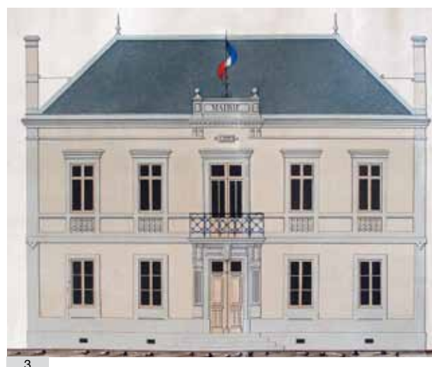
3. Soin du détail sur la façade principale monumentale et symbolique. A noter le dessin des petits bois sur les baies différent entre RDC et étage (source Archives Départementales 65).
