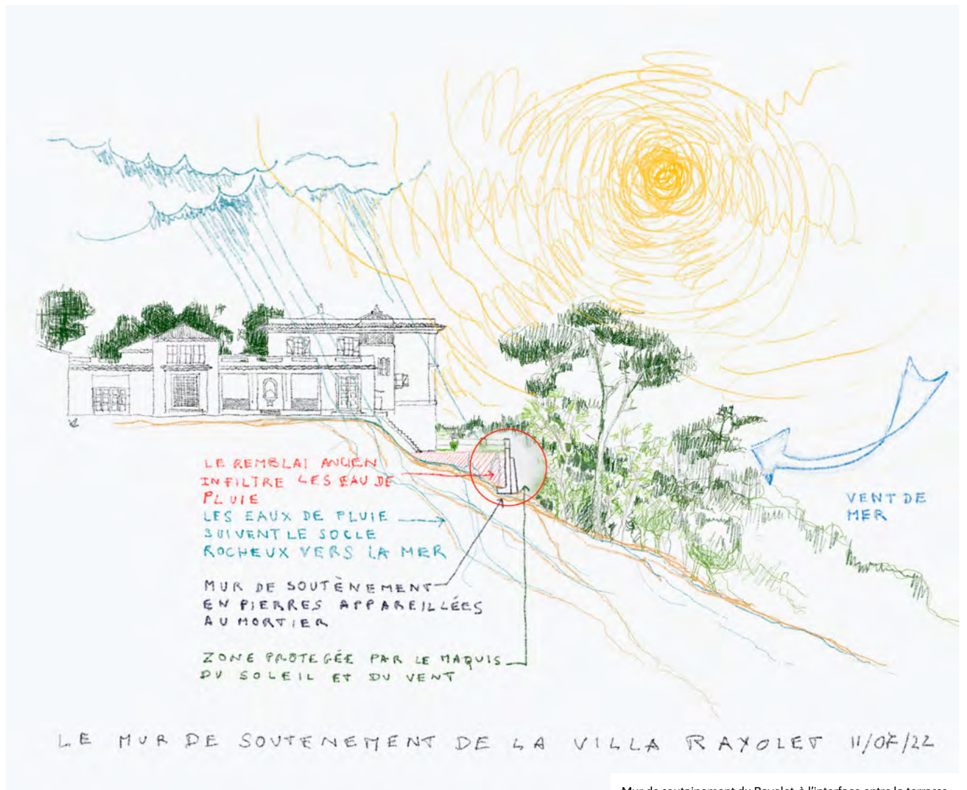
Mur de soutènement du Rayolet, à l'interface entre la terrasse et la garrigue | © Xavier LAGURGUE, architecte Agence XLGD architectures
