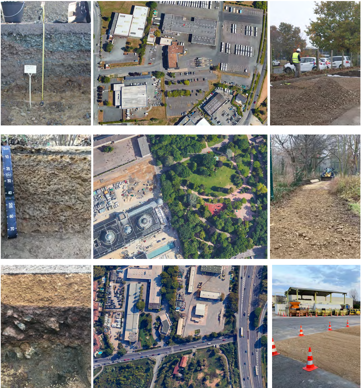
De gauche à droite : profils de sols scellés, vues aériennes des sites et mise en place des pilotes de terrain. (haut : Angers / R. Dagois ; milieu : Nancy / C. Schwartz ; bas : Cannes / S. Ouvrard)
